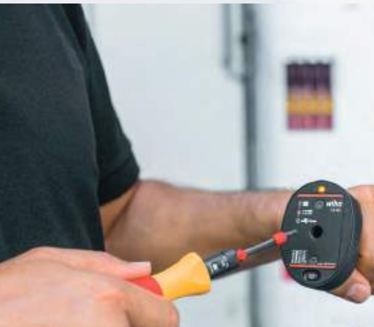
Mobil kontroll av vridmomentverktyg
